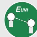
两点之间的长度误差, 将测量值与标准值进行比较
